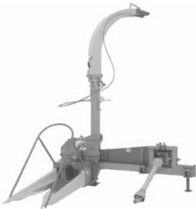
Figura 1. Colhedora de forragem JF 90 Z 10
