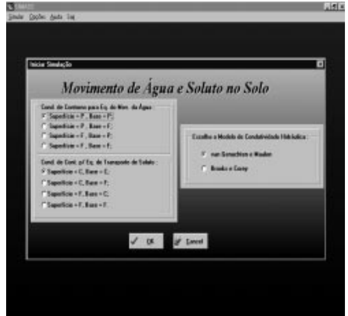
Figura 3. Tela do SIMASS mostrando opção de escolha das condições de contorno e do modelo a ser utilizado na determinação da condutividade hidráulica do solo
